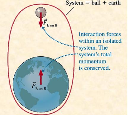
$P_{\rm f} = m_{\rm b}v_{\rm b} + m_{\rm e}v_{\rm e} = P_{\rm i} = 0 \implies v_{\rm e} = -\frac{m_{\rm b}}{m_{\rm e}}v_{\rm b}$
